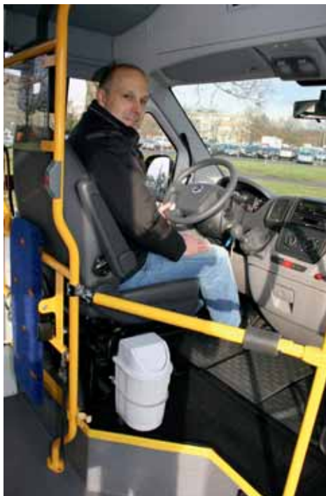
Der Arbeitsplatz wirkt ergonomisch, der rote Türöffner ist zu entfernt platziert.
