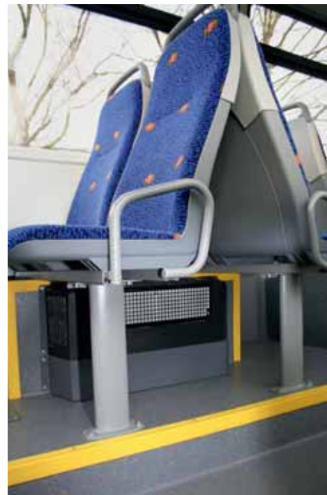
Das zweistufige Gebläse bringt den Innenraum zügig auf angenehme Temperaturen.
